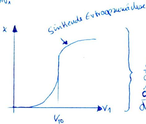
$$\left. \begin{array}{l} \frac{d^2x}{dv_1^2} > 0 \text{ für } v_1 < v_{10} \\ \frac{d^2x}{dv_1^2} < 0 \text{ für } v_1 > v_{10} \end{array} \right\}$$
