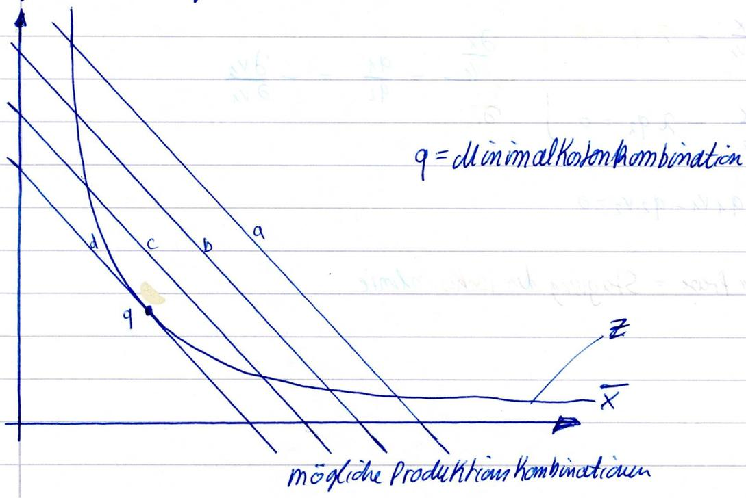
⇒ Man geht mit der Isokostenlinie solange runter bis sie die Isoquantenkurve gerade noch berührt → dort ist der Kostenminimale Punkt bei gegebenem Output.
